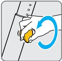
1. Поверните ручку против часовой стрелки, чтобы ослабить винт.
