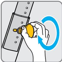
5. Зафиксируйте винт, вращая ручку по часовой стрелке
